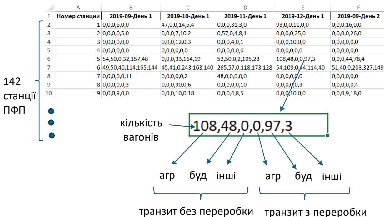
Рис. 7. Структура масиву даних навчальної вибірки про вагонопотоки та схема кодування виду вагонопотоків для кожної станції ПФП
