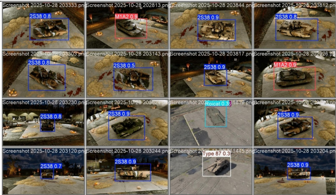
Рис. 2. Результати детекції об'єкта бронетехніки в умовах складного фону з відображенням ступеня довіри алгоритму
