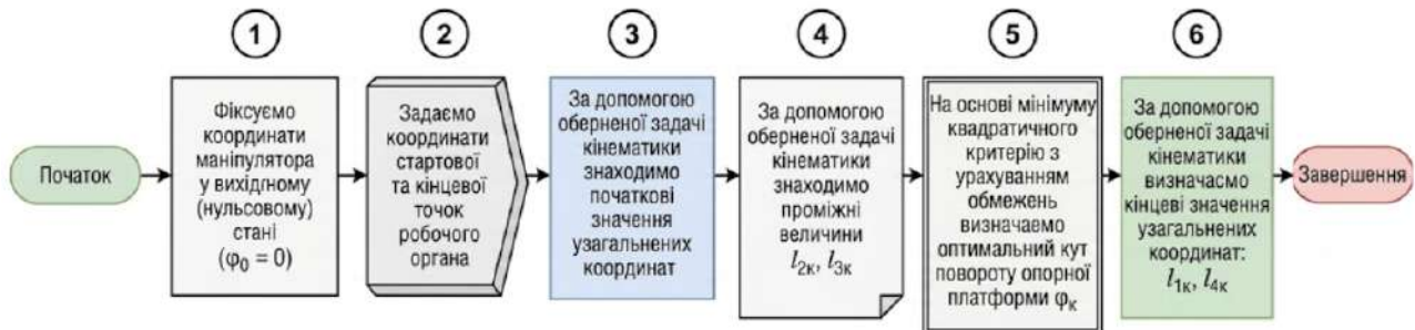
Рис. 3. Структурна схема алгоритму розв'язання задачі позиціонування маніпулятора
