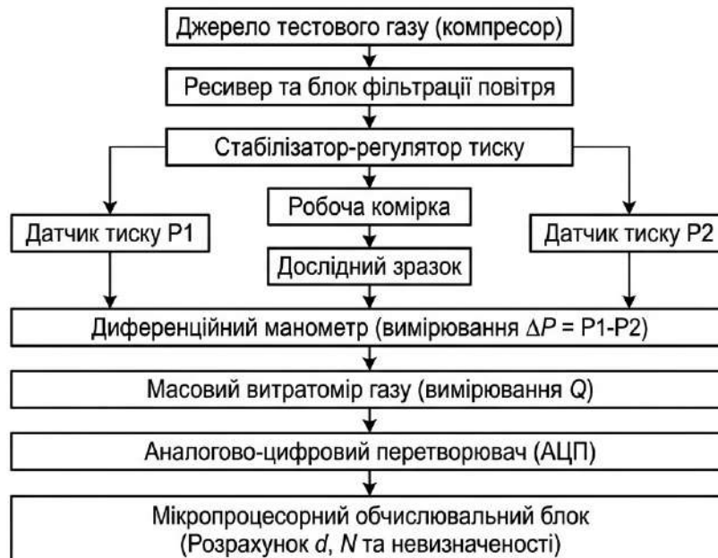
Рис. 1. Функціонально-структурна схема інформаційно-вимірювальної системи контролю параметрів пористості
